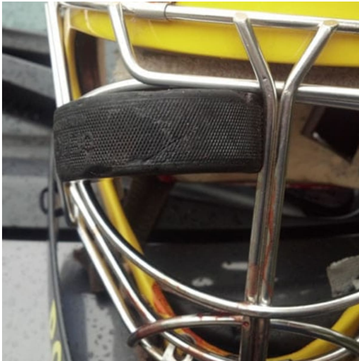
Kuva 16: kiekko ei mahdu aikuisten käyttämän cat-eye -ristikon läpi ristikon ollessa ehjä. Lankojen vääntyessä kiekko voi kuitenkin tehdä ikävää vahinkoa. Junioreilla tätä ongelmaa ei suoranaisesti ole, mutta vaaratilanteen voi aiheuttaa vääntynyt ristikko, jonka lanka katkeaa osumasta sohaisten maalivahtia kasvoille. Kiekon lisäksi myös mailan lapa voi tehdä odottamattoman pahaa jälkeä.
